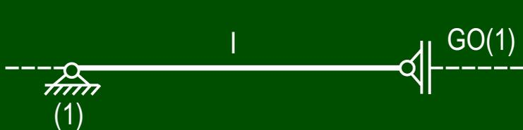
Der Hauptpol (1) der Scheibe I liegt im festen Gelenklager und soll gleichzeitig irgendwo (GO) auf einer Geraden liegen, die durch das Gleitlager längs der Stabachse läuft, was kein Widerspruch für die Lage von (1) ist.
