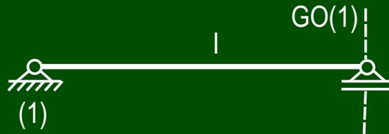
Der Hauptpol (1) der Scheibe I liegt im festen Gelenklager und soll gleichzeitig irgendwo (GO) auf einer Geraden liegen, die durch das Gleitlager quer zur Stabachse läuft, was ein Widerspruch für die Lage von (1) ist.
