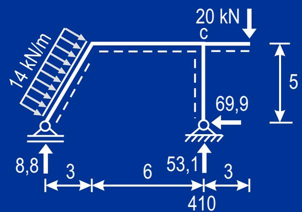
Die Momente mit den wahren Drehrichtungen (nach Diagramm links) antragen
