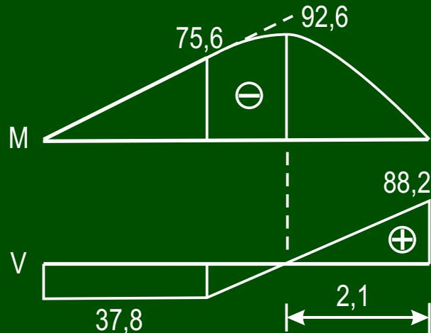
Unter einer konstanten Linienlast ist die M-Linie eine quadratische Parabel. Der Bauch der Parabel zeigt in Lastrichtung. Der Übergang von der Parabel in die Gerade erfolgt tangential.
