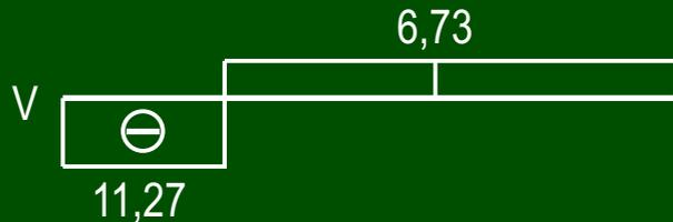
Unter einem Moment hat die M-Linie einen Sprung. Die Sprunghöhe entspricht der Größe des Moments.
