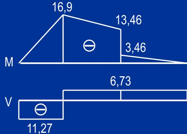
Unter einem Moment hat die M-Linie einen Sprung. Die Sprunghöhe entspricht der Größe des Moments.
