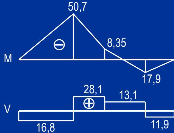
Unter einer Einzellast (Stützkräfte sind auch Einzellasten) hat die M-Linie einen Knick. Der Knick zeigt in Richtung der Pfeilspitze.
