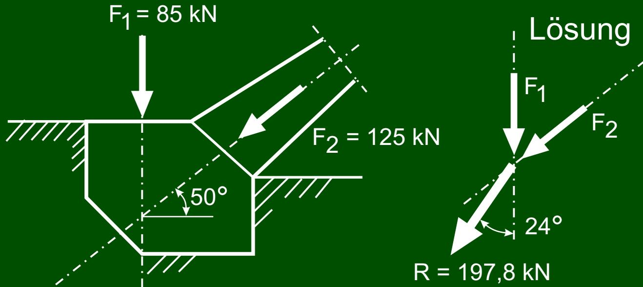
Größe, Richtung (Winkel) und Richtungssinn (Pfeilspitze) der Resultierenden  $R$ , die den Kräften  $F_1$ ,  $F_2$  und  $F_3$  äquivalent ist. Äquivalenzbedingung verwenden.
