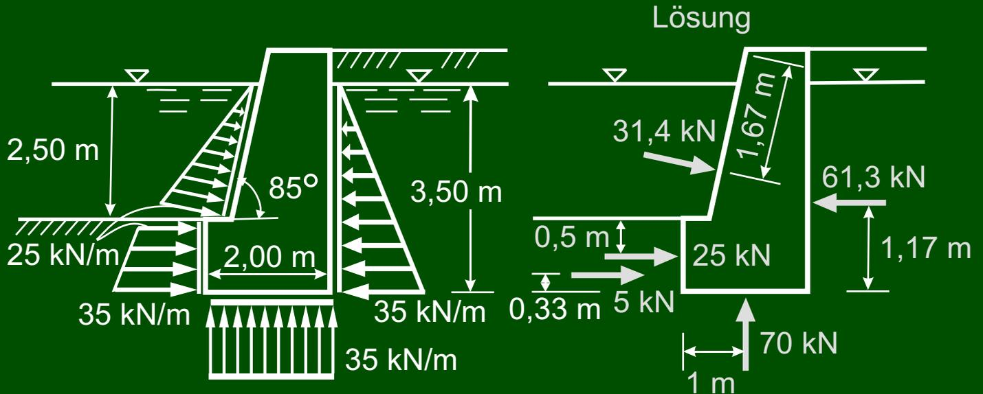
Berechnung der Momente in den Punkten a, b und c. Der Drehsinn der Momente, auf den sich das Ergebnis bezieht, ist vor dem Beginn der Berechnung frei wählbar. Hier wurde im Uhrzeigersinn als positiver Drehsinn gewählt.
