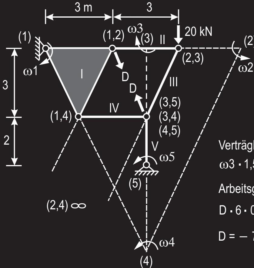
Die Stabkraft D kann als an Scheibe I oder II bzw. als an Scheibe III, IV oder V angreifend gedacht werden. Die Last 20 kN kann zur Scheibe I oder III gehörend angesehen werden (siehe das erste Beispiel).
