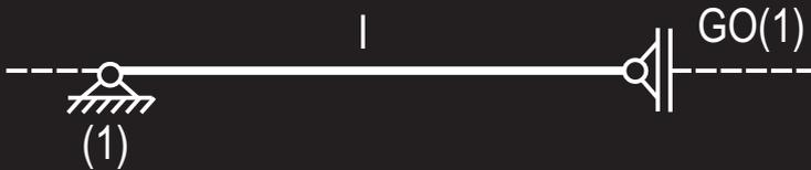
Der Hauptpol (1) der Scheibe I liegt im festen Gelenklager und soll gleichzeitig irgendwo (GO) auf einer Geraden liegen, die durch das Gleitlager längs der Stabachse läuft, was kein Widerspruch für die Lage von (1) ist.
