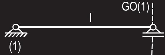
Der Hauptpol (1) der Scheibe I liegt im festen Gelenklager und soll gleichzeitig irgendwo (GO) auf einer Geraden liegen, die durch das Gleitlager quer zur Stabachse läuft, was ein Widerspruch für die Lage von (1) ist.
